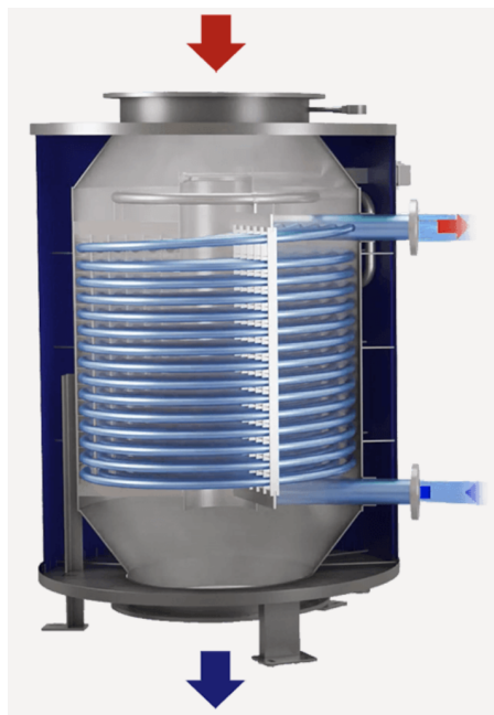
Obrázek 6.1: Schématické zobrazení spalínového výměníku Aalborg Micro ve vertikálním uspořádání. Převzato z [26].
